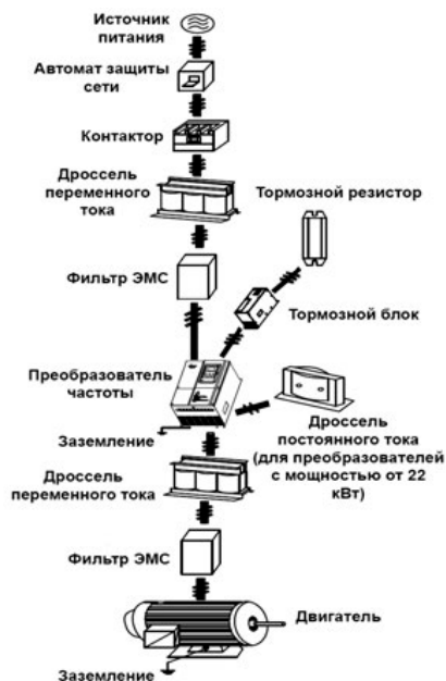
Рис. 1-2. Подключение преобразователя частоты
